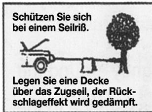
Wenn Sie eine schwere Last ziehen, legen Sie eine schwere Decke oder Jacke ca. 1,5 m vom Lasthaken entfernt über das Zugseil. Dies dämpft im Falle, dass das Seil reißt, den Rückschlageffekt.
