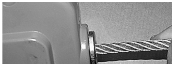
Abb. 4 + Abb. 5 Führen Sie nun das Seilende vorn in das Gerät ein und schieben Sie das Seil durch, bis es hinten, oberhalb des Ankerbolzens, wieder austritt.
