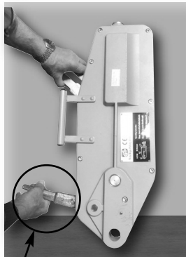
Abb. 2 Stellen Sie den unteren Bedienhebel waagrecht.
