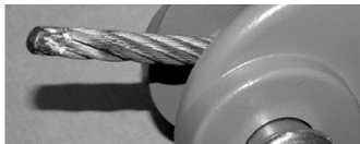
Abb. 4 + Abb. 5 Führen Sie nun das Seilende vorn in das Gerät ein und schieben Sie das Seil durch, bis es hinten, oberhalb des Ankerbolzens, wieder austritt.
